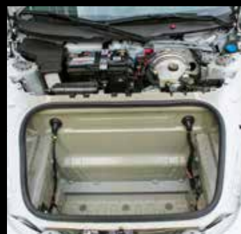
Tous les habillages du coffre avant ont été enlevés pour gagner du poids
